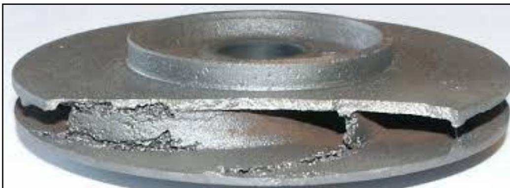
Figura 2 – Cavitação em um rotor.
