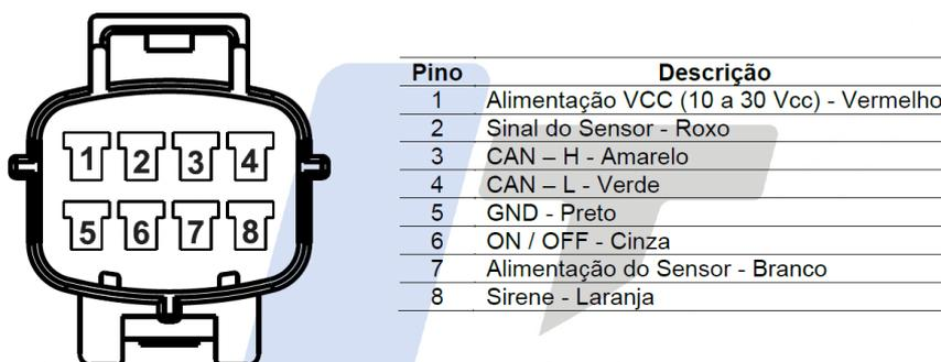
Figura 21 – Ligação elétrica do conector do painel do nível.
