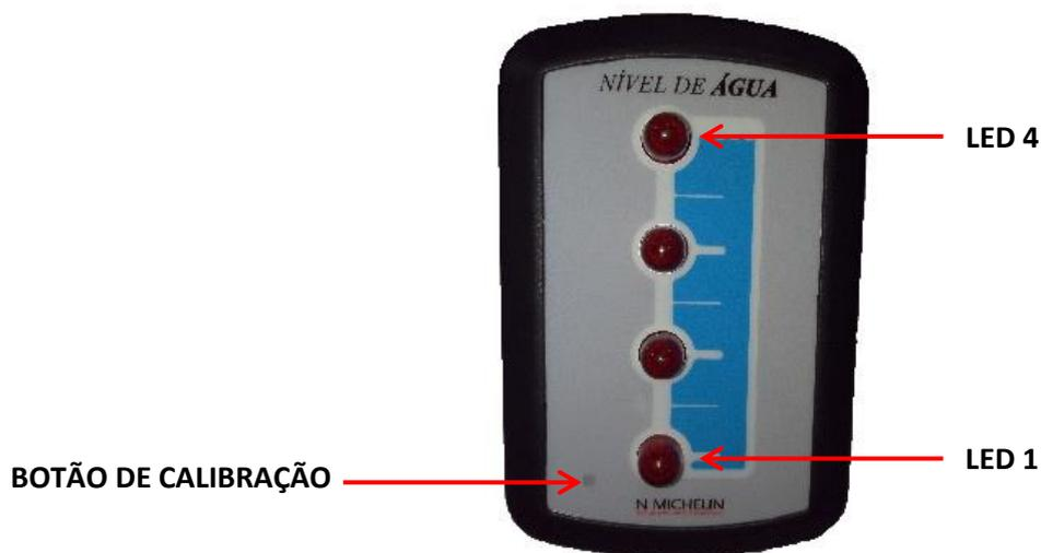
Figura 22 – Equipamento posicionado calibrado.
